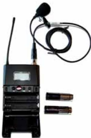
Deckel am Taschensender öffnen, dazu Schnapper links und rechts gleichzeitig drücken. Zwei neue Batterien einlegen. Auf die Polung achten (Minuspol beim Federkontakt, links)!
