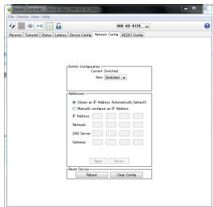
2. Utilice el elemento Switch Configuration para elegir el modo operativo del puerto Ethernet.
