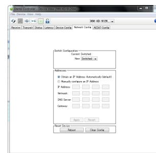
2. Utilisez le paramètre Switch Configuration pour sélectionner le mode de fonctionnement du port Ethernet.
